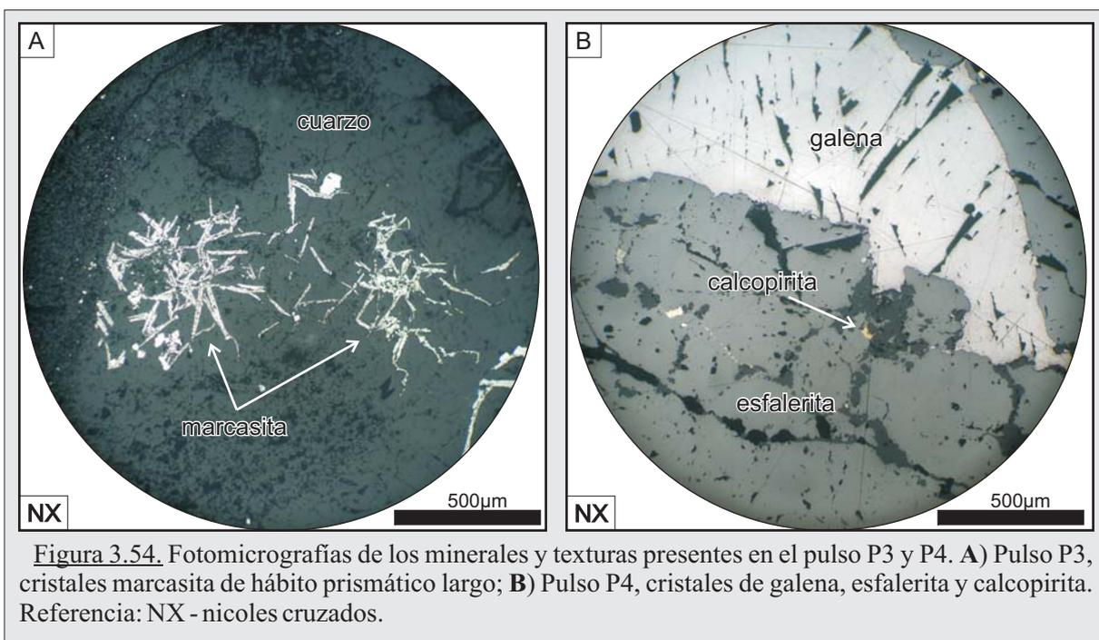
Figura 3.54. Fotomicrografías de los minerales y texturas presentes en el pulso P3 y P4. A) Pulso P3, cristales marcasita de hábito prismático largo; B) Pulso P4, cristales de galena, esfalerita y calcopirita. Referencia: NX - nicoles cruzados.
