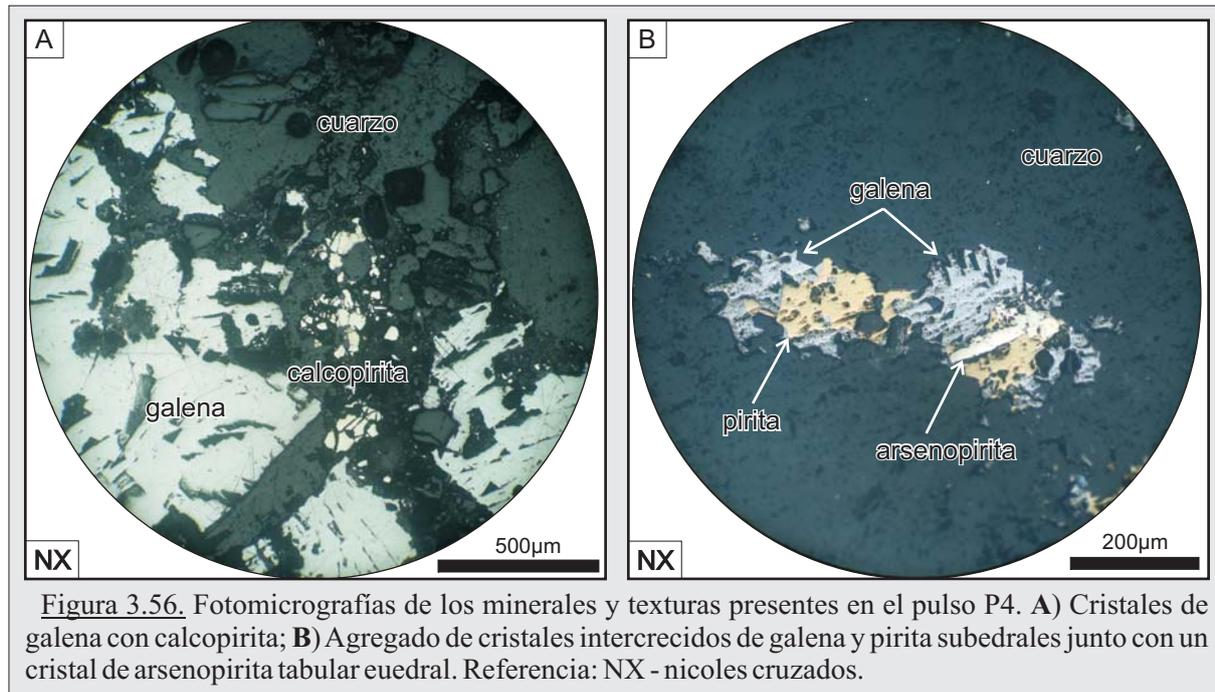
Figura 3.56. Fotomicrografías de los minerales y texturas presentes en el pulso P4. A) Cristales de galena con calcopirita; B) Agregado de cristales intercrecidos de galena y pirita subedrales junto con un cristal de arsenopirita tabular euedral. Referencia: NX - nicoles cruzados.
