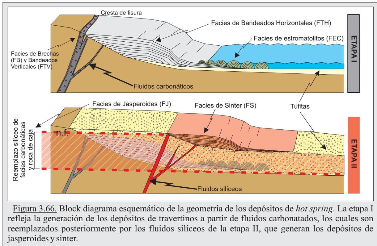
Figura 3.66. Block diagrama esquemático de la geometría de los depósitos de *hot spring*. La etapa I refleja la generación de los depósitos de travertinos a partir de fluidos carbonatados, los cuales son reemplazados posteriormente por los fluidos silíceos de la etapa II, que generan los depósitos de jasperoides y sinter.
