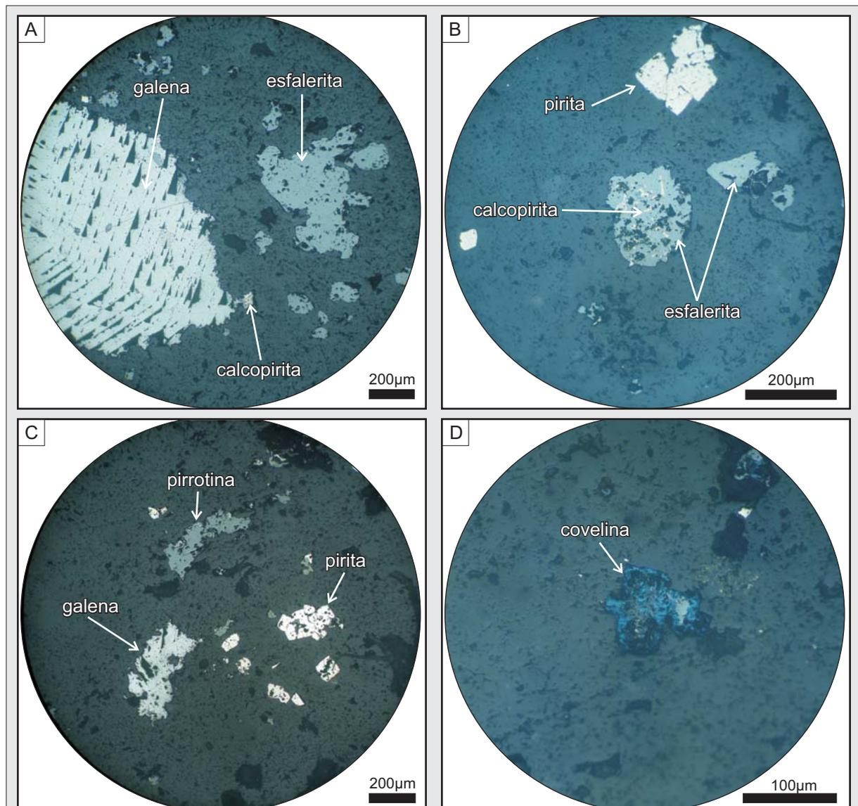
**Figura 3.32.** Fotomicrografías de los sulfuros presentes en el pulso P3. **A)** Galena de gran tamaño con bordes irregulares junto a cristales de esfalerita subedrales y escasa calcopirita; **B)** Cristales de esfalerita con desmezcla de calcopirita; **C)** Pirrotina subedral asociada a galena y pirita; **D)** Cristal eudral de covelina.
