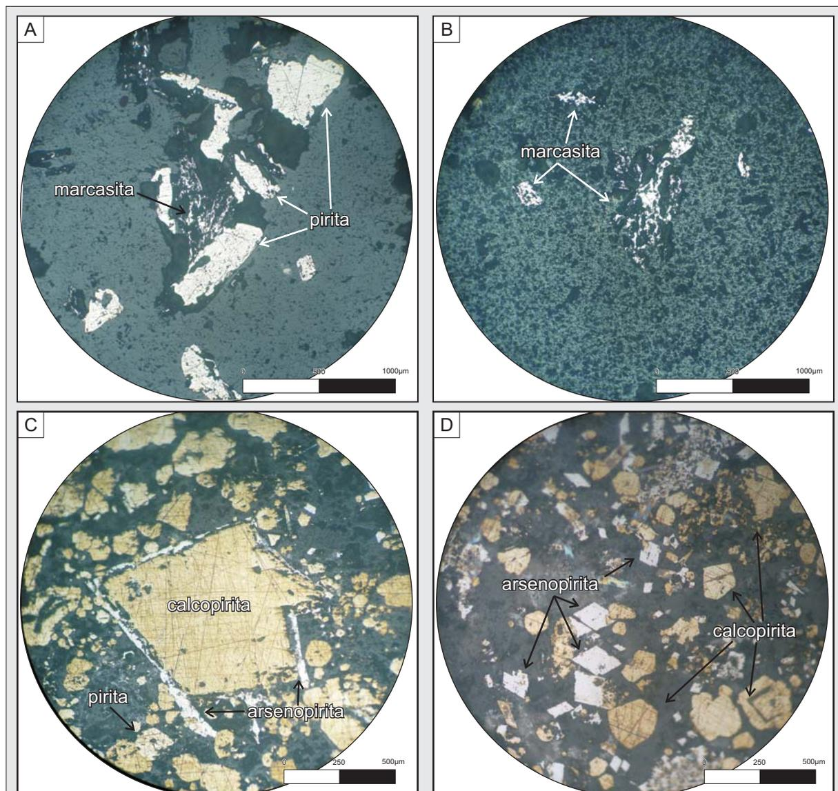
Figura 3.10. Área Wendy - Fotomicrografías de los sulfuros presentes en el pulso P4. A) Pirita subedrales creciendo junto a marcasita; B) Detalle de los cristales de marcasita con un hábito radiado y aspecto corroído; C) Calcopirita subedral con rebordes de arsenopirita, en un agregado de pequeño cristales de calcopirita+pirita+arsenopirita; D) Cristales eudrales rómbicos de arsenopirita.
