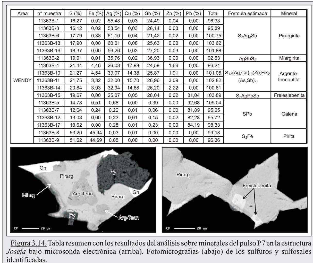
Figura 3.14. Tabla resumen con los resultados del análisis sobre minerales del pulso P7 en la estructura Josefa bajo microsonda electrónica (arriba). Fotomicrografías (abajo) de los sulfuros y sulfosales identificadas.
