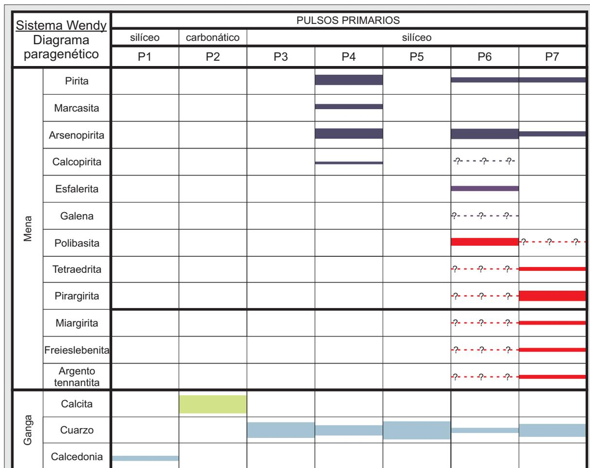
Figura 3.7. Diagrama paragenético del área Wendy, en donde se observa la presencia de los diferentes minerales de mena y ganga en cada uno de los siete pulsos mineralizantes como reflejo de la evolución que sufrió el fluido hidrotermal. El grosor de las barras refleja la abundancia del mineral en cada pulso.
