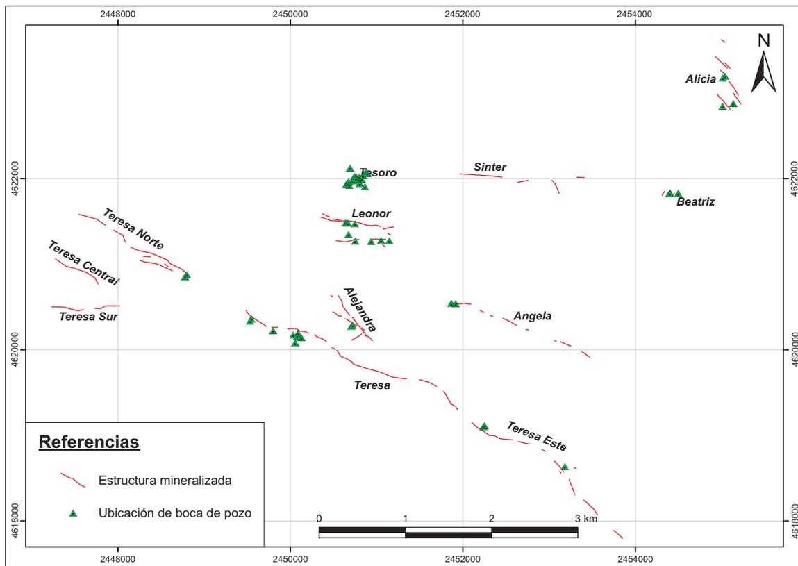
**Figura 3.60.** Mapa de ubicación de las estructuras mineralizadas del Sistema Malbec con la localización de los pozos perforados en el período 2002-2008. En la tabla V se detallan el total de pozos realizados, su profundidad y los valores anómalos hallados.
