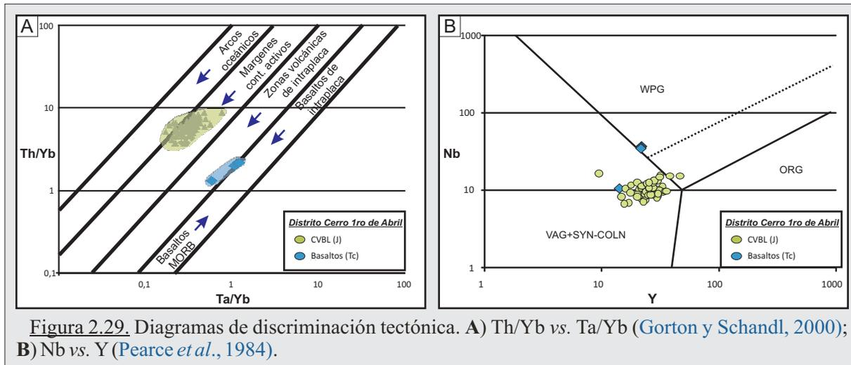
Figura 2.29. Diagramas de discriminación tectónica. A) Th/Yb vs. Ta/Yb (Gorton y Schandl, 2000); B) Nb vs. Y (Pearce *et al.*, 1984).
