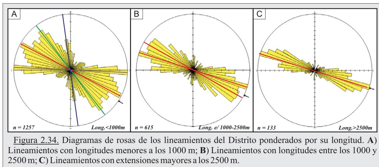
Figura 2.34. Diagramas de rosas de los lineamientos del Distrito ponderados por su longitud. A) Lineamientos con longitudes menores a los 1000 m; B) Lineamientos con longitudes entre los 1000 y 2500 m; C) Lineamientos con extensiones mayores a los 2500 m.
