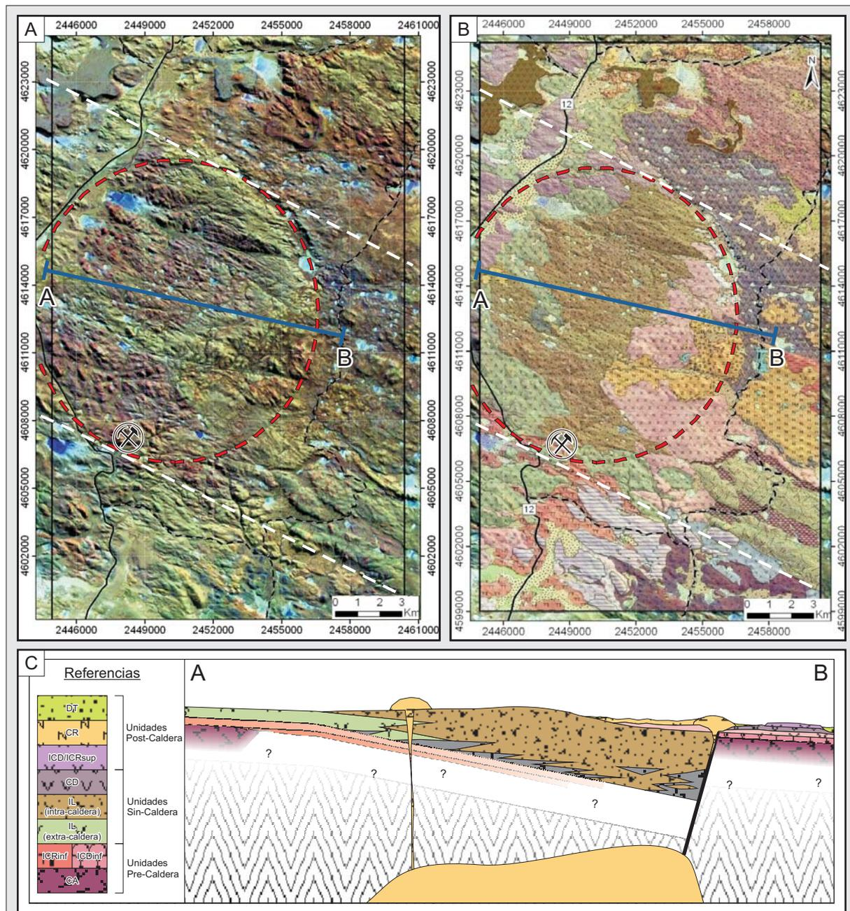
Figura 4.8. Caldera Cerro Primero de Abril. Ubicación del rasgo morfo-estructural subcircular de 12km de diámetro limitado por dos lineamientos mayores de rumbo ONO-ESE. A) Imagen Landsat TM-Spot; B) Mapa geológico; C) Perfil esquemático A-B de la caldera tipo trap-door.
