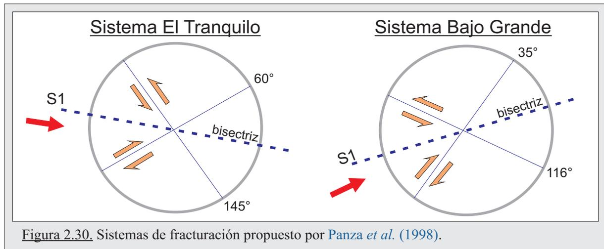
Figura 2.30. Sistemas de fracturación propuesto por Panza *et al.* (1998).
