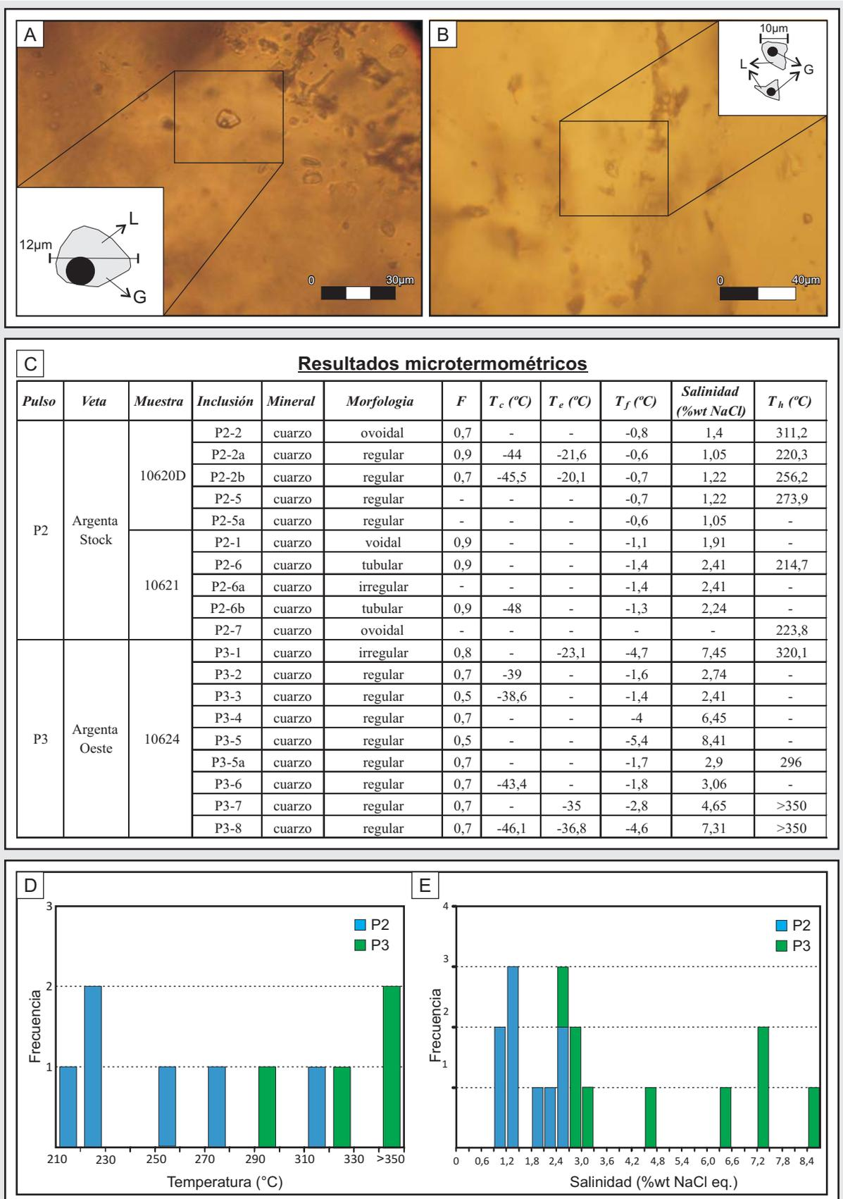
Figura 3.34. A) y B) Fotomicrografías de las inclusiones fluidas presentes en el pulso P2 (muestra 10620D); C) Tabla resumen de los principales datos microtermométricos obtenidos para el Sistema Argenta. D) Gráfico de Frecuencia vs. Temperatura; E) Gráfico de Frecuencia vs. Salinidad.
