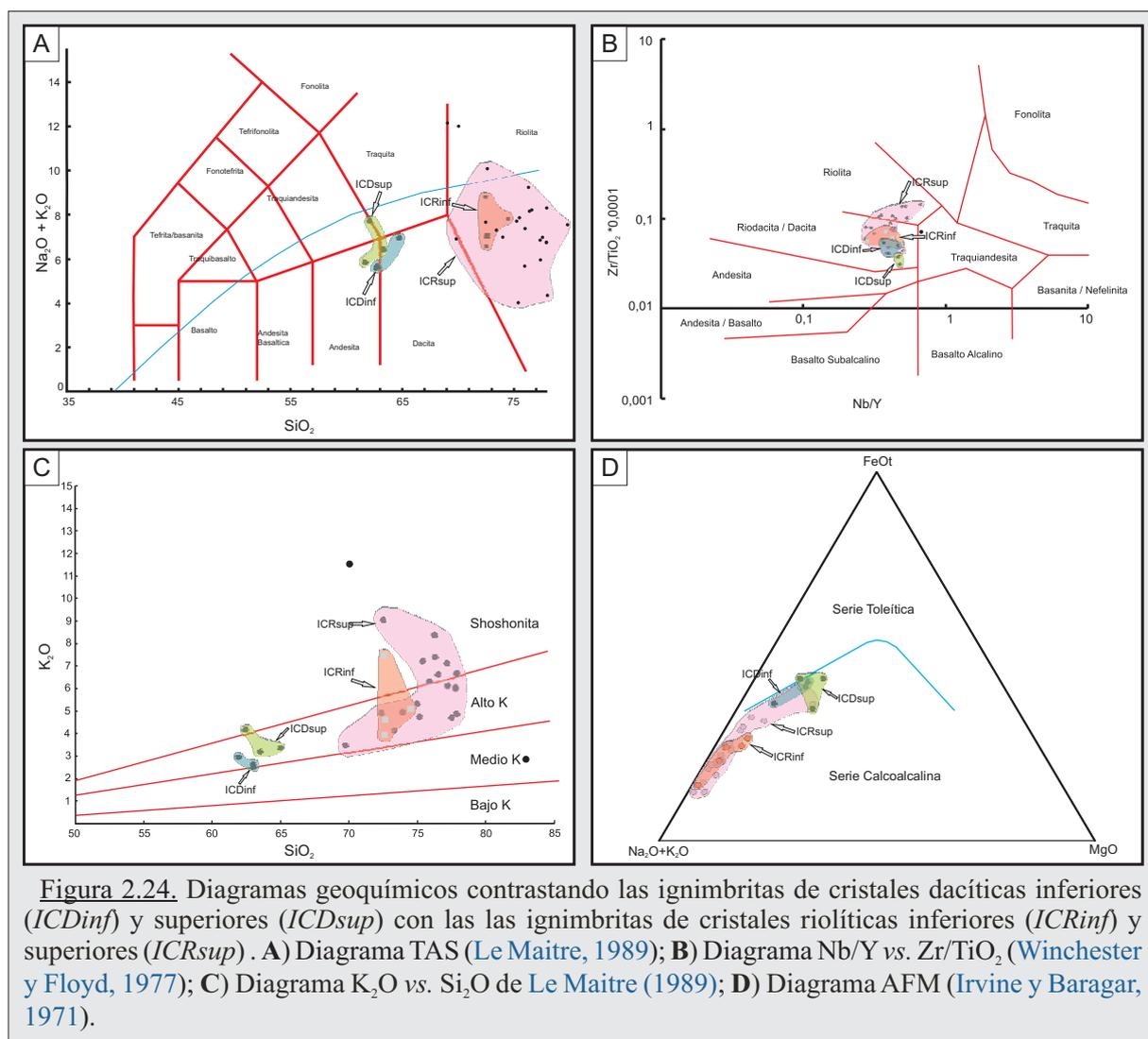
Figura 2.24. Diagramas geoquímicos contrastando las ignimbritas de cristales dacíticos inferiores (*ICDinf*) y superiores (*ICDsup*) con las las ignimbritas de cristales riolíticas inferiores (*ICRinf*) y superiores (*ICRsup*). **A)** Diagrama TAS (Le Maitre, 1989); **B)** Diagrama Nb/Y vs. Zr/TiO<sub>2</sub> (Winchester y Floyd, 1977); **C)** Diagrama K<sub>2</sub>O vs. Si<sub>2</sub>O de Le Maitre (1989); **D)** Diagrama AFM (Irvine y Baragar, 1971).
