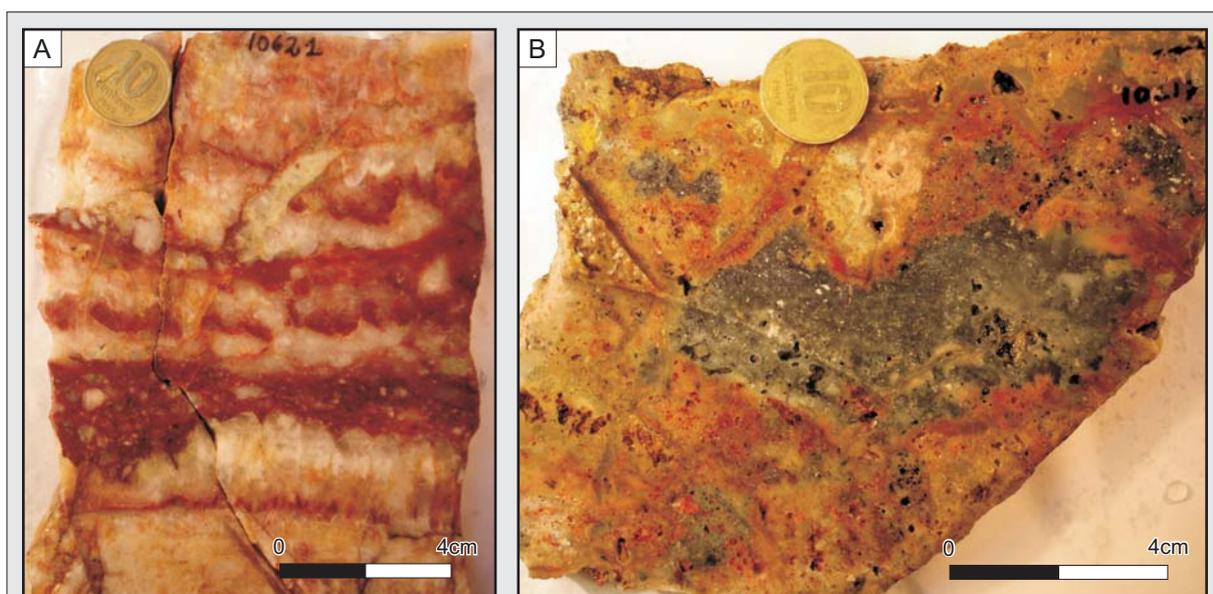
Figura 3.31. Vista en muestras de mano de las brechas hidrotermales del pulso P3. **A)** Muestra de la brecha con clastos del pulso previo en una matriz silíceo ferruginosa; **B)** muestra de la brecha con el núcleo fresco rico en un pulso silíceo con abundante galena y pirita, con el borde fuertemente oxidado.
