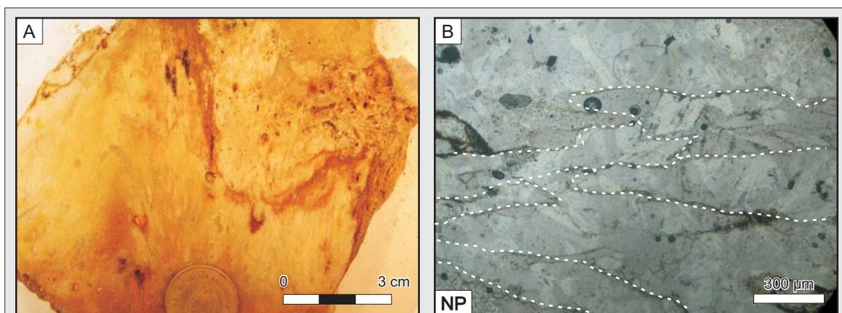
**Figura 3.28.** Pulso P1. **A)** detalle de la calcita parcialmente reemplazada por sílice en la estructura *Argenta madre*; **B)** Vista al microscopio de las calcitas laminares (en líneas punteadas se resaltó los límites entre individuos). NP: nicoles paralelos.
