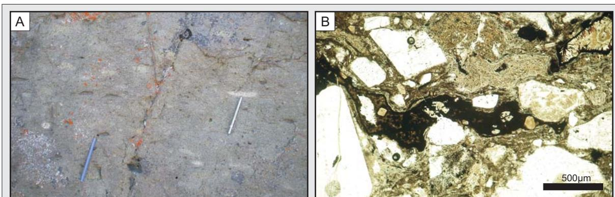
**Figura 2.10.** Ignimbritas Líticas (IL). **A)** Detalle de los afloramientos de la toba lítica (TL), donde se destacan los dos tipos de *fiammes* que caracterizan a esta unidad; **B)** Microfotografía de los dos *fiammes* de composiciones diferentes: el superior con matriz castaña clara y de composición feno-riolítica, mientras que el inferior con matriz castaña oscura y de composición feno-andesítica.
