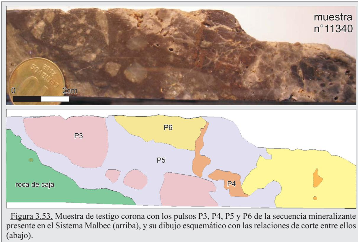
Figura 3.53. Muestra de testigo corona con los pulsos P3, P4, P5 y P6 de la secuencia mineralizante presente en el Sistema Malbec (arriba), y su dibujo esquemático con las relaciones de corte entre ellos (abajo).
