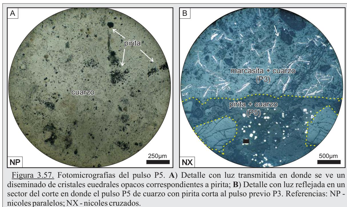
Figura 3.57. Fotomicrografías del pulso P5. A) Detalle con luz transmitida en donde se ve un diseminado de cristales euedrales opacos correspondientes a pirita; B) Detalle con luz reflejada en un sector del corte en donde el pulso P5 de cuarzo con pirita corta al pulso previo P3. Referencias: NP - nicoles paralelos; NX - nicoles cruzados.
