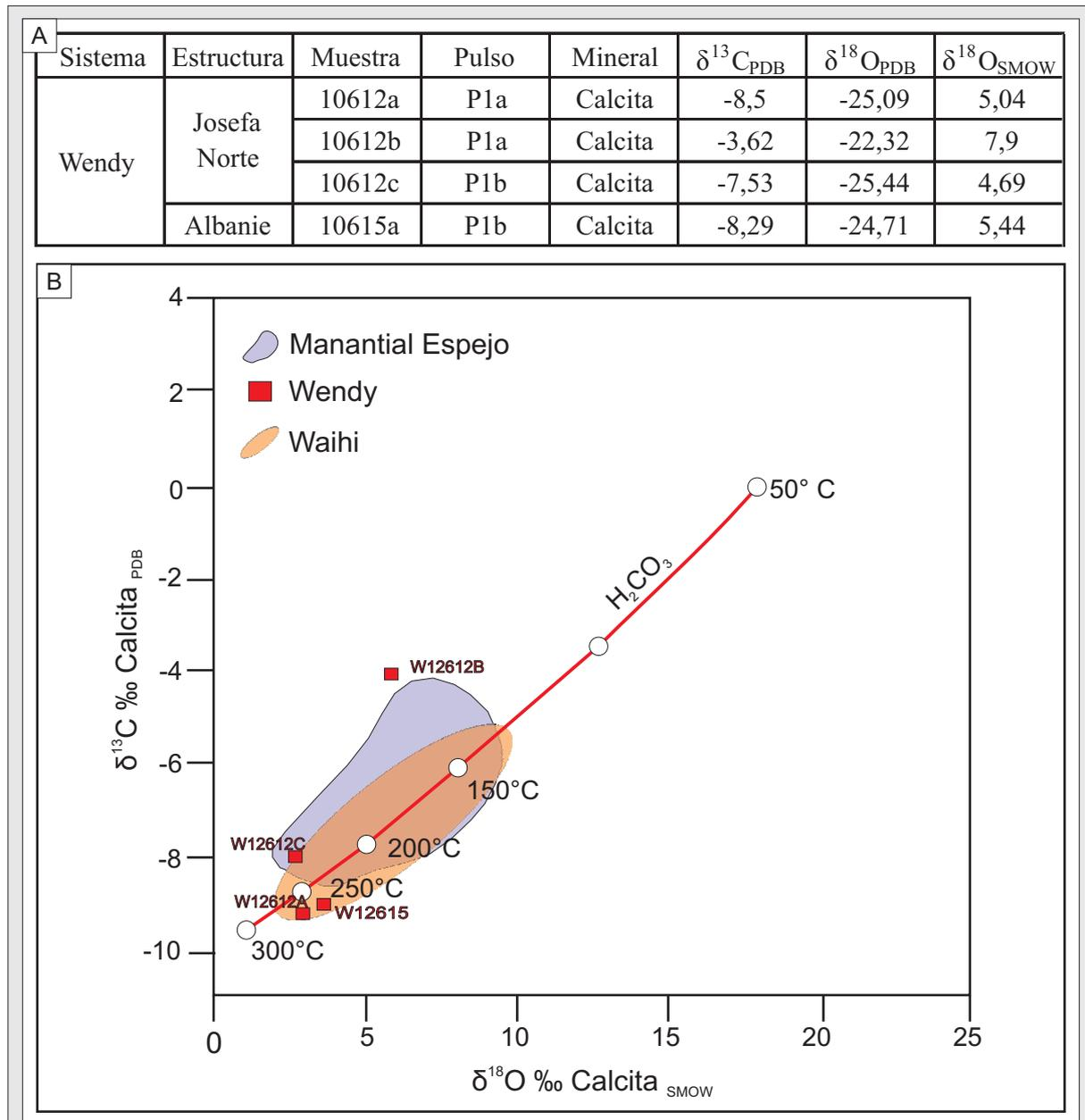
Figura 3.67. Wendy. A) Tabla resumen con los resultados de los ensayos isotópicos realizados sobre calcitas de los pulsos P1a y P1b; B) Diagrama  $\delta^{13}\text{C}$  calcita (‰) vs.  $\delta^{18}\text{O}$  calcita (‰). La curva representa el tren de equilibrio de fraccionamiento en función de la temperatura para la calcita, asumiendo que  $\text{H}_2\text{CO}_3$  es la especie dominante de carbono acuoso (modificado de Simmons y Christenson, 1994).
