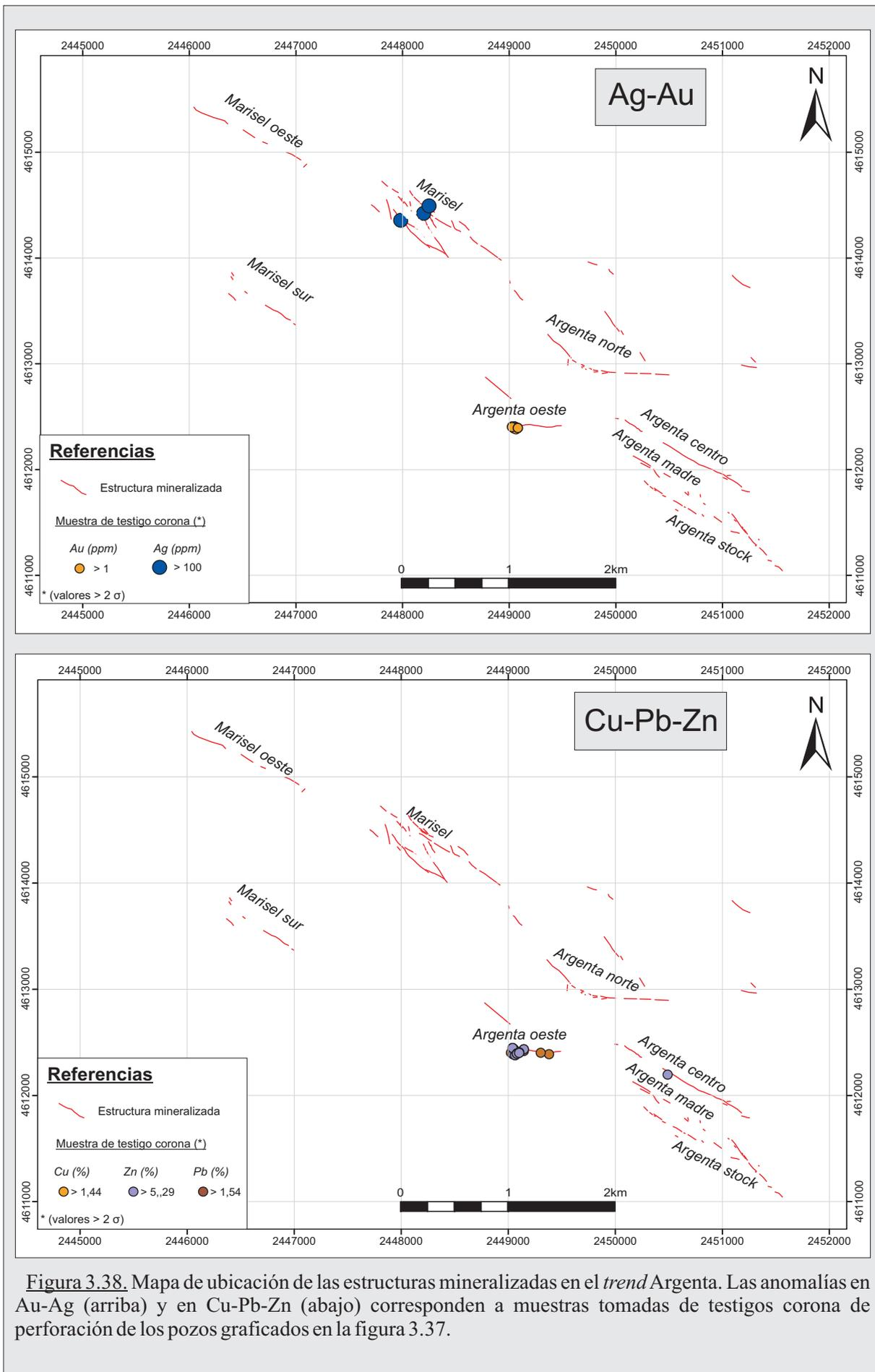
Figura 3.38. Mapa de ubicación de las estructuras mineralizadas en el *trend* Argenta. Las anomalías en Au-Ag (arriba) y en Cu-Pb-Zn (abajo) corresponden a muestras tomadas de testigos corona de perforación de los pozos graficados en la figura 3.37.
