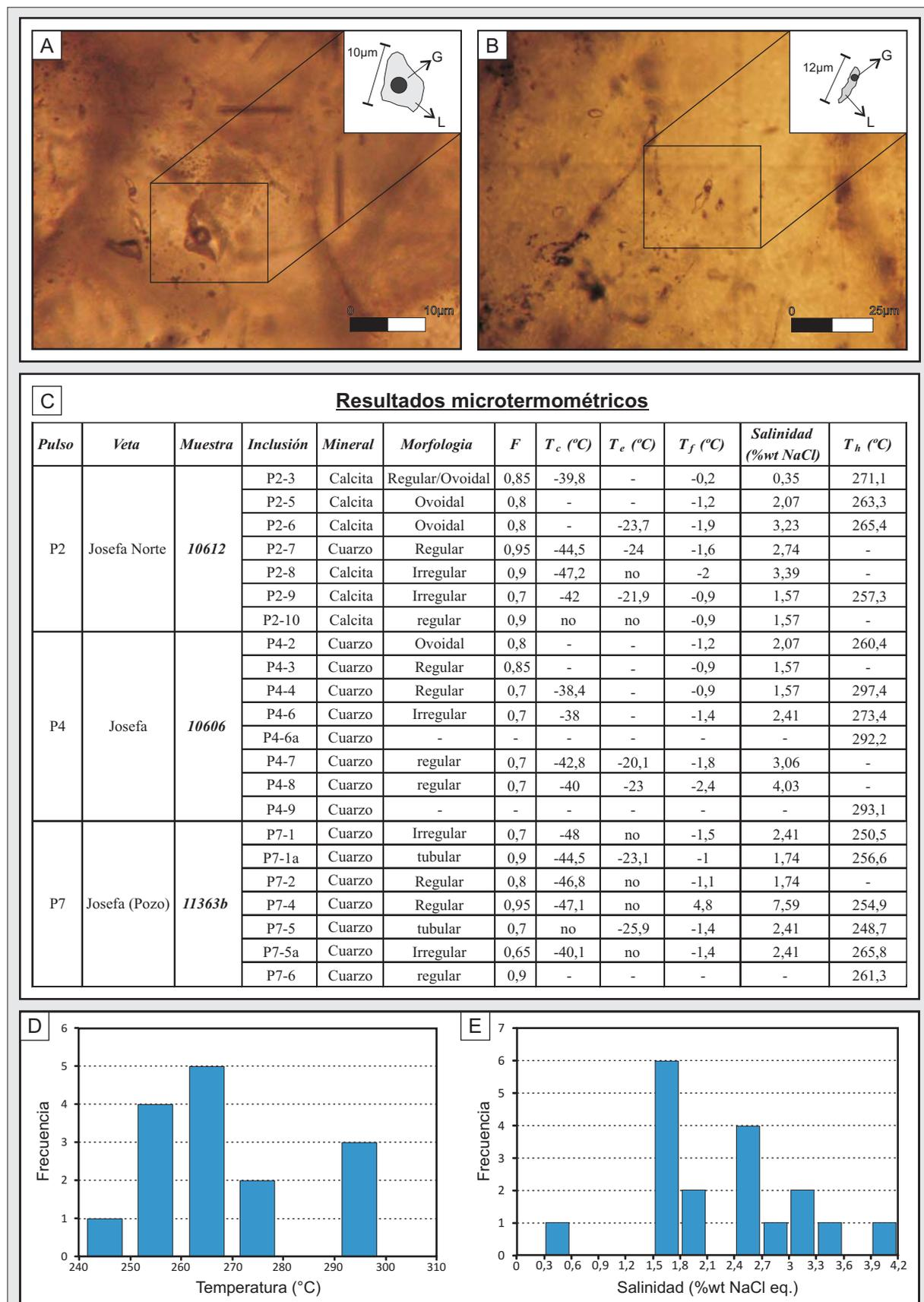
Figura 3.15. A) Fotomicrografías de las IF presentes en el pulso P4 (muestra 10606); B) Fotomicrografías de las IF presentes en el pulso P7 (muestra 11363). C) Tabla resumen de los principales datos microtermométricos obtenidos en las IF del trend Wendy. D) Gráfico de Frecuencia vs. Temperatura. E) Gráfico de Frecuencia vs. Salinidad, marcando claramente las dos modas existentes entre los 1,5-1,8 y 2,4-2,7 wt% NaCl eq.
