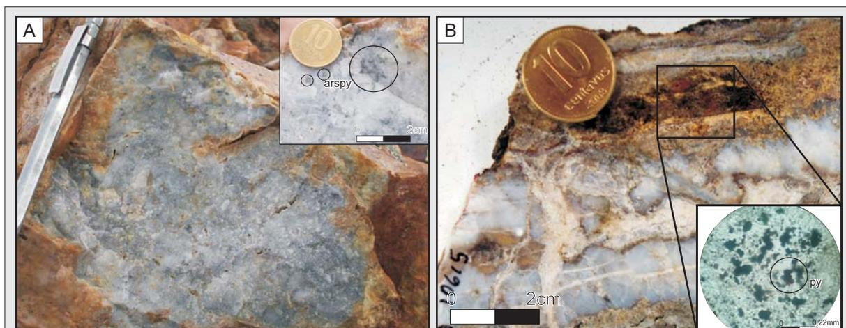
**Figura 3.5.** Wendy Principal. **A)** Intersección *Josefa-Zulema*, muestra de mano y detalle de los sulfuros diseminados (principalmente arsenopirita fresca); **B)** Estructura *Albanie*, muestra de mano y detalle al microscopio de los cristales de pirita oxidados.
