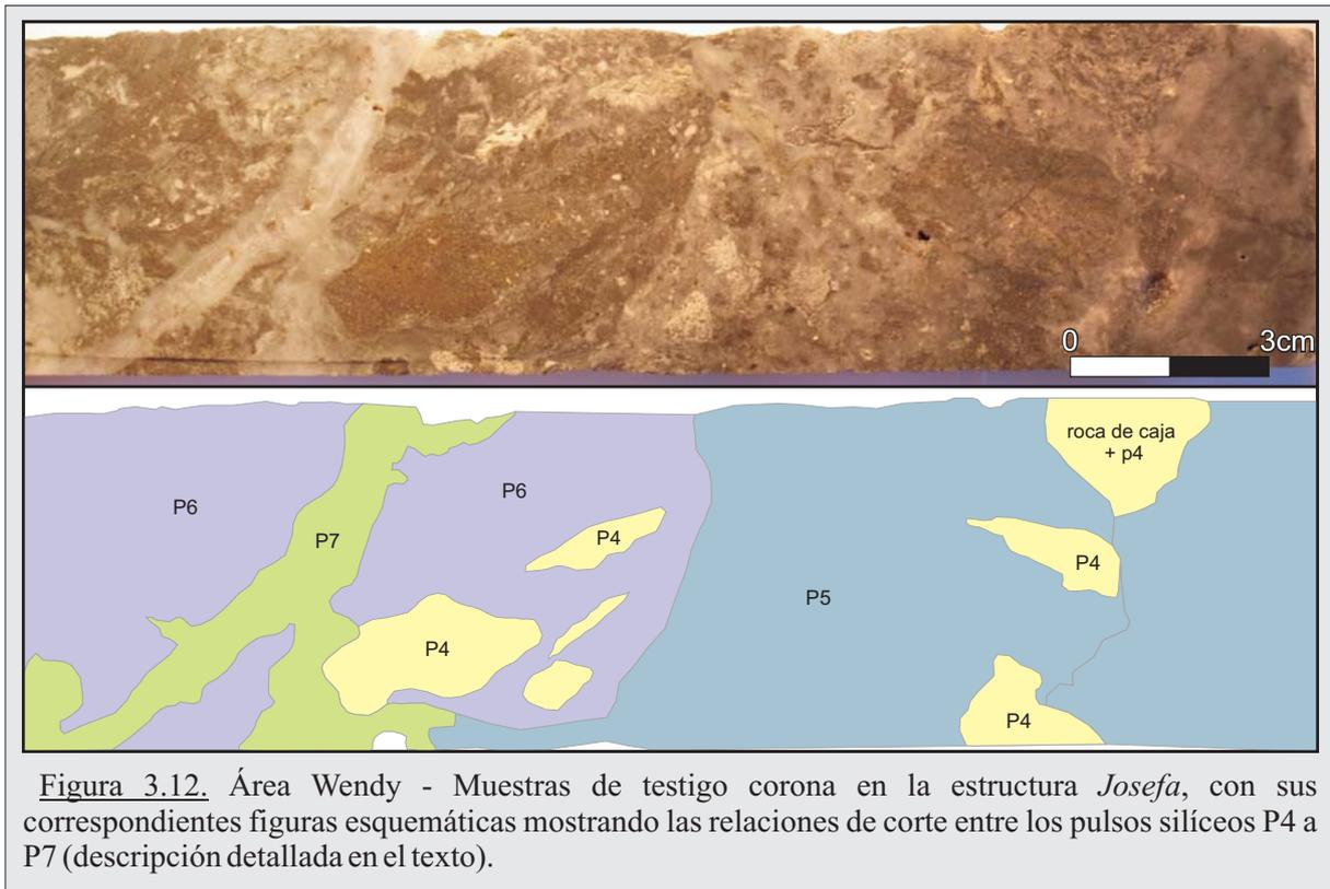
**Figura 3.12.** Área Wendy - Muestras de testigo corona en la estructura *Josefa*, con sus correspondientes figuras esquemáticas mostrando las relaciones de corte entre los pulsos silíceos P4 a P7 (descripción detallada en el texto).
