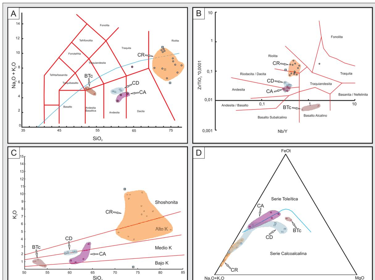
**Figura 2.23.** Diagramas geoquímicos integrando los datos obtenidos en los Complejos CA, CD y CR y en las lavas básicas terciarias (BTc), presentes en el Distrito. **A)** Diagrama TAS (Le Maitre, 1989); **B)** Diagrama Nb/Y vs. Zr/TiO<sub>2</sub> (Winchester y Floyd, 1977); **C)** Diagrama K<sub>2</sub>O vs. Si<sub>2</sub>O de Le Maitre (1989); **D)** Diagrama AFM (Irvine y Baragar, 1971).
