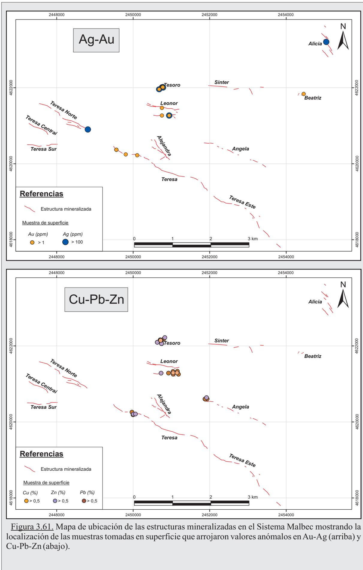
Figura 3.61. Mapa de ubicación de las estructuras mineralizadas en el Sistema Malbec mostrando la localización de las muestras tomadas en superficie que arrojaron valores anómalos en Au-Ag (arriba) y Cu-Pb-Zn (abajo).
