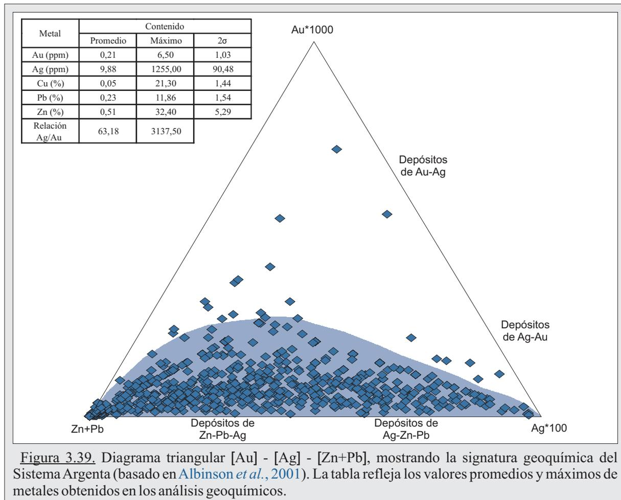
Figura 3.39. Diagrama triangular [Au] - [Ag] - [Zn+Pb], mostrando la signatura geoquímica del Sistema Argenta (basado en Albinson *et al.*, 2001). La tabla refleja los valores promedios y máximos de metales obtenidos en los análisis geoquímicos.
