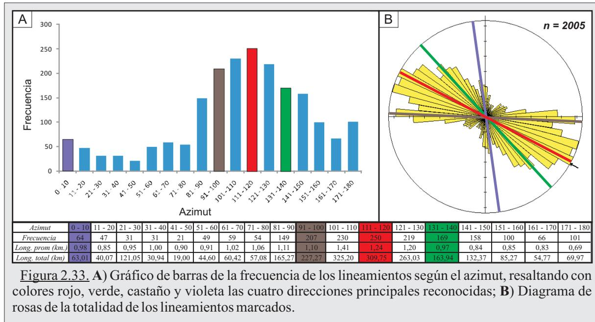
Figura 2.33. A) Gráfico de barras de la frecuencia de los lineamientos según el azimut, resaltando con colores rojo, verde, castaño y violeta las cuatro direcciones principales reconocidas; B) Diagrama de rosas de la totalidad de los lineamientos marcados.
