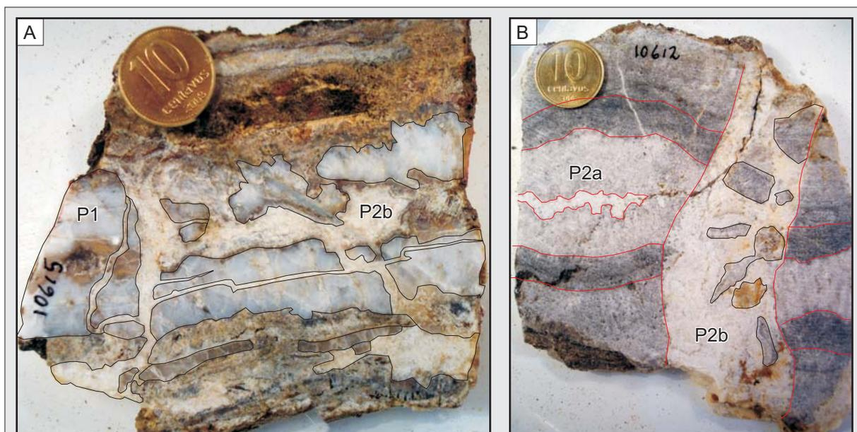
Figura 3.8. A) *Albanie*, donde se observa al pulso calcedónico P1 cortado por el pulso carbonático P2b; B) *Josefa Norte*, se reconoce el pulso P2a con un bandeo paralelo cortado por el P2b con textura brechosa.
